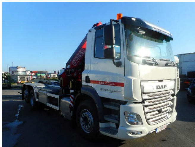
DAF CF 480 FAN - containerhooksystem + FASSI F235A.2.23 6x2
